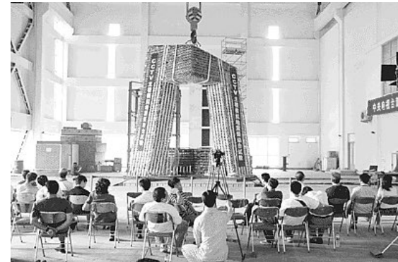
CCTV OMA. Prueba de estabilidad de modelo estructural sobre plataforma móvil
